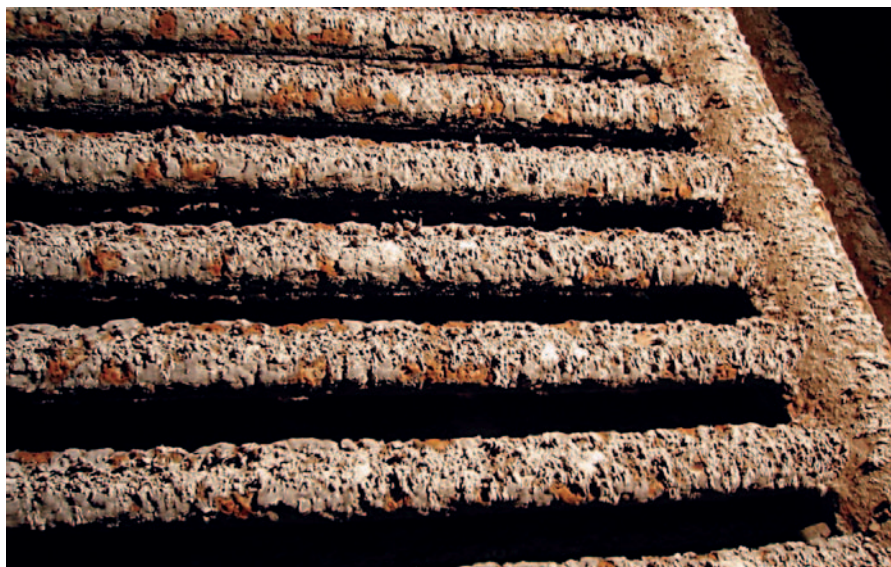
Sind die Wärmeplatten verschmutzt, verringert sich die Energieausbeute.
